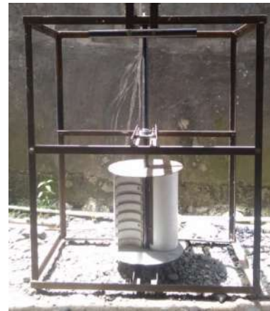
Gambar 4. Savonius dengan 8 alur
