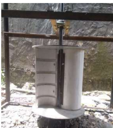
Gambar 3. Savonius dengan 4 alur
